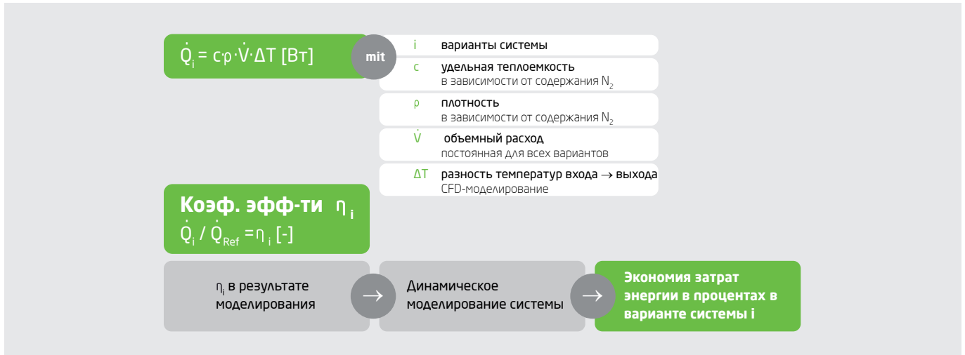
Рис. 161: Определение коэффициента эффективности как относительного значения систем, содержащих газ в большом количестве и со сниженным содержанием газа
