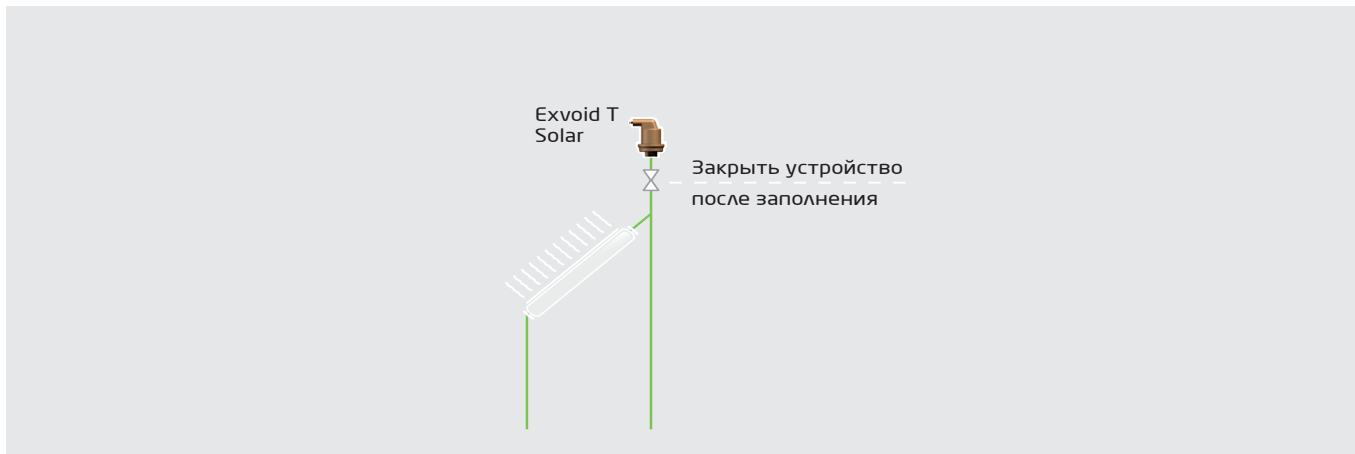
Рис. 142: Вытесняющая дегазация воздухоотводчиком Exvoid T Solar в солнечной установке
