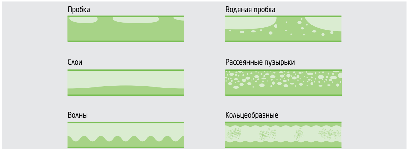
Рис. 83. Характер воздушных включений в горизонтальных трубопроводах [Ghajar, 2005]
