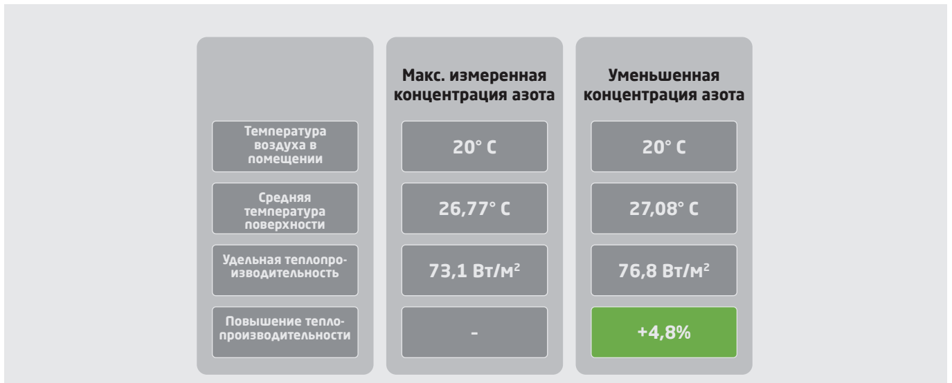
Рис. 160: Сравнение температуры поверхности и удельной теплопроизводительности
